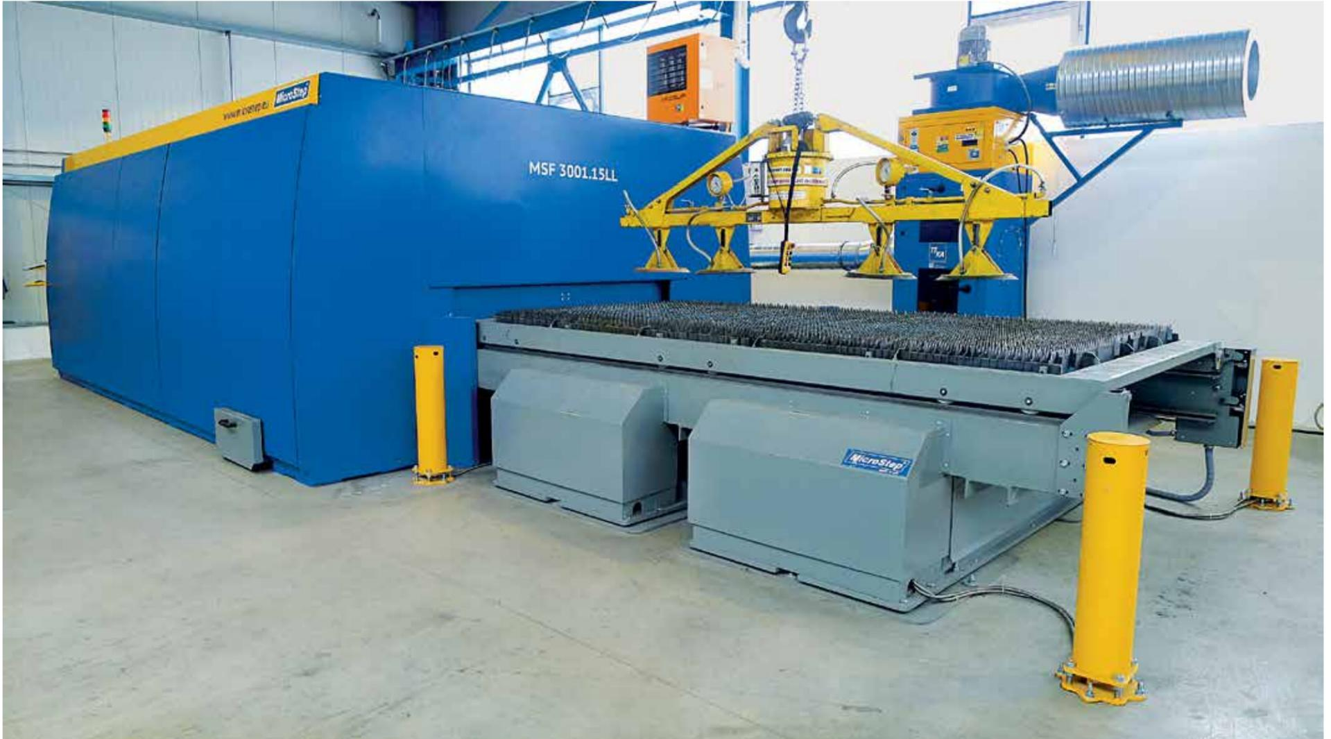
La MSF es un sistema de corte por láser de gran potencia para el corte de materiales con un láser de fibra, o una combinación de láser y plasma. La máquina está diseñada para la producción de piezas de alta precisión a altas velocidades de corte, con unos bajos costes de operación y de mantenimiento. La dinámica de la MSF se consigue mediante un pórtico especial, variadores digitales y engranajes planetarios precisos. La máquina está equipada con una mesa intercambiable automática.
