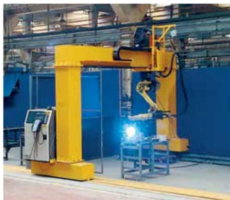
ponentes para células de trabajo robóticas, diferentes tipos de posicionadores, sistemas tipo pórtico y de vigas transversales, vallas de seguridad y células de soldadura modulares estandarizadas.
