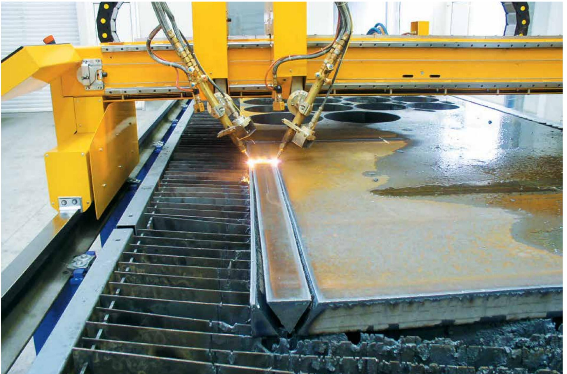
La OxyCutes una máquina de corte CNC de un alto rendimiento y muy fiable, diseñada para el corte oxicorte totalmente automático o una combinación de oxicorte y corte por plasma. La OxyCut está equipada con un sistema de control de gases con
