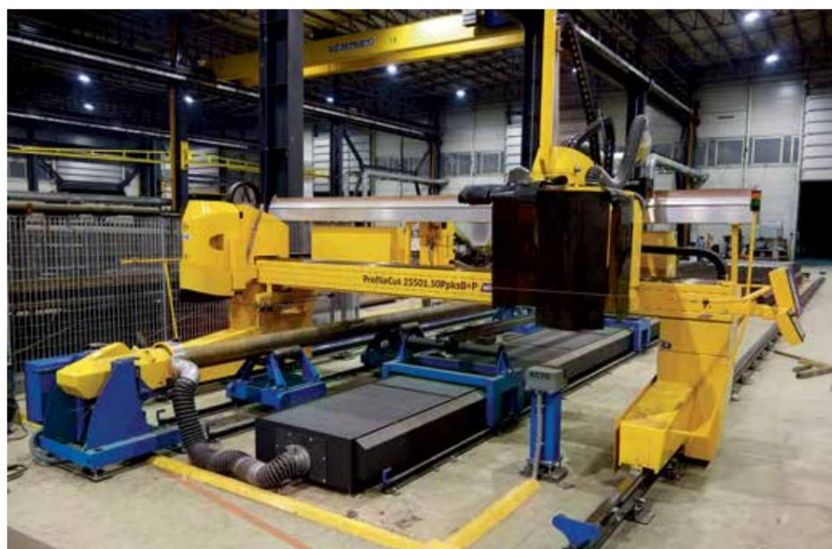
para asegurar el apoyo del perfil de corte durante el proceso de corte. Una máquina de corte puede estar equipada con un cabezal de biseado con un rango de inclinación de ±50° que permite el corte con la preparación de soldadura automática, incluso para una intesección compleja de tubos, o de tubos y perfiles rectangulares. Para el corte de secciones abiertas, tales
