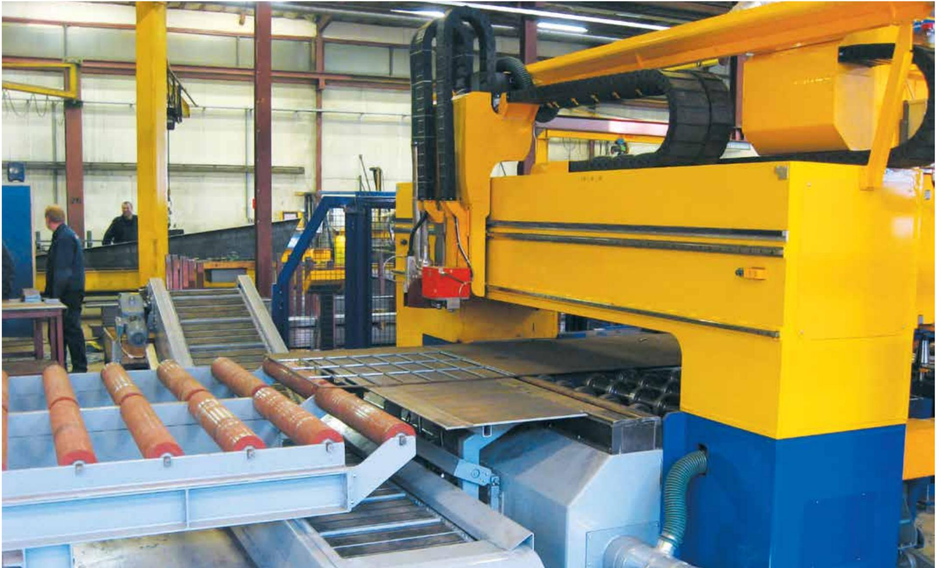
La DS está diseñada para la perforación y corte con una alta eficiencia y con la posibilidad de alineación automática de planchas y clasificación automática de piezas en la salida. La línea de procesamiento de planchas se dedica a aplicaciones estructurales de acero de alta resist-
