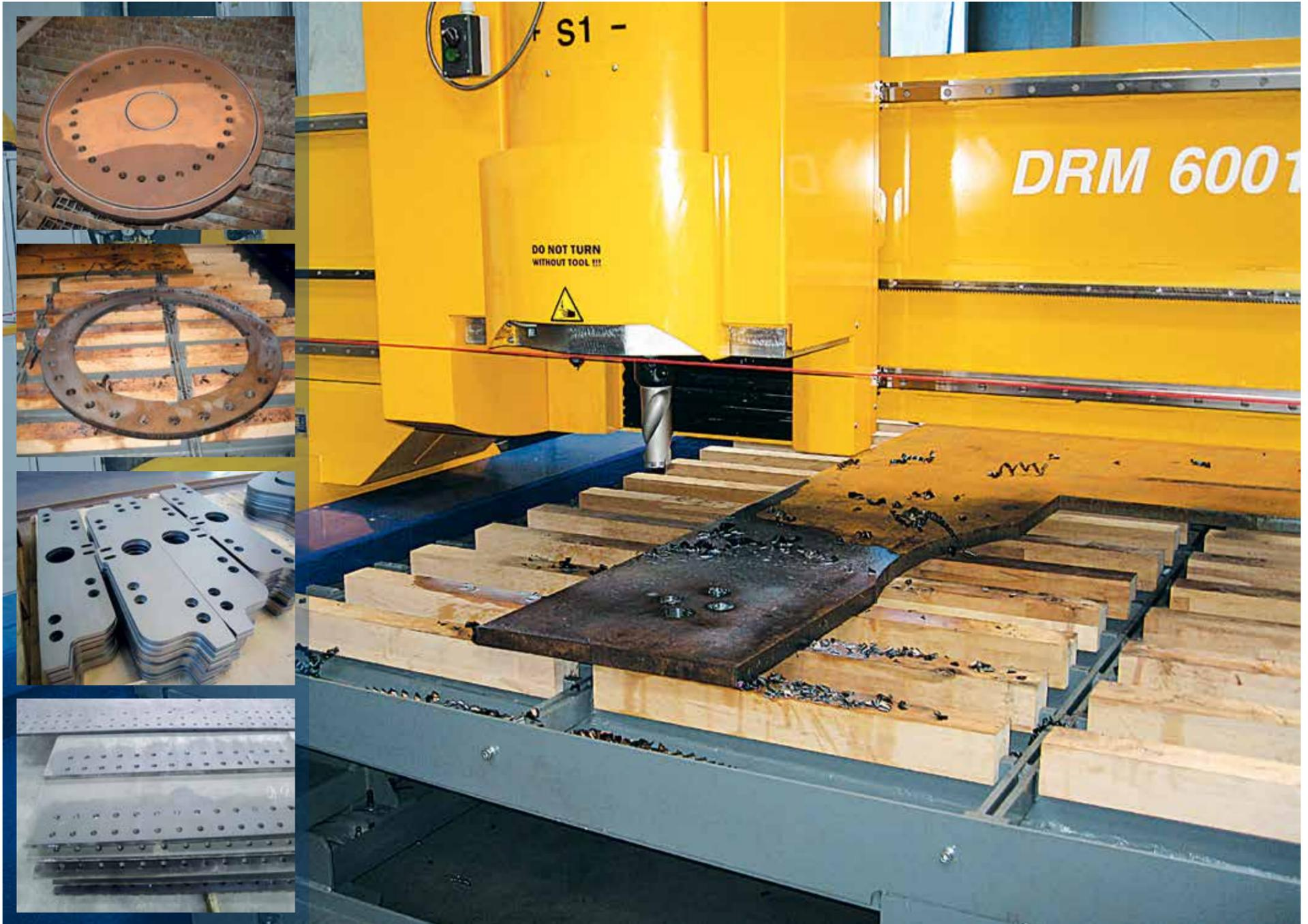
La máquina DRM-B está diseñada para el trabajo pesado de perforación CNC de planchas de construcción, planchas tubulares para intercambiadores de calor y otros trabajos de perforación exigentes. La máquina está equipada con una mesa de perforación
