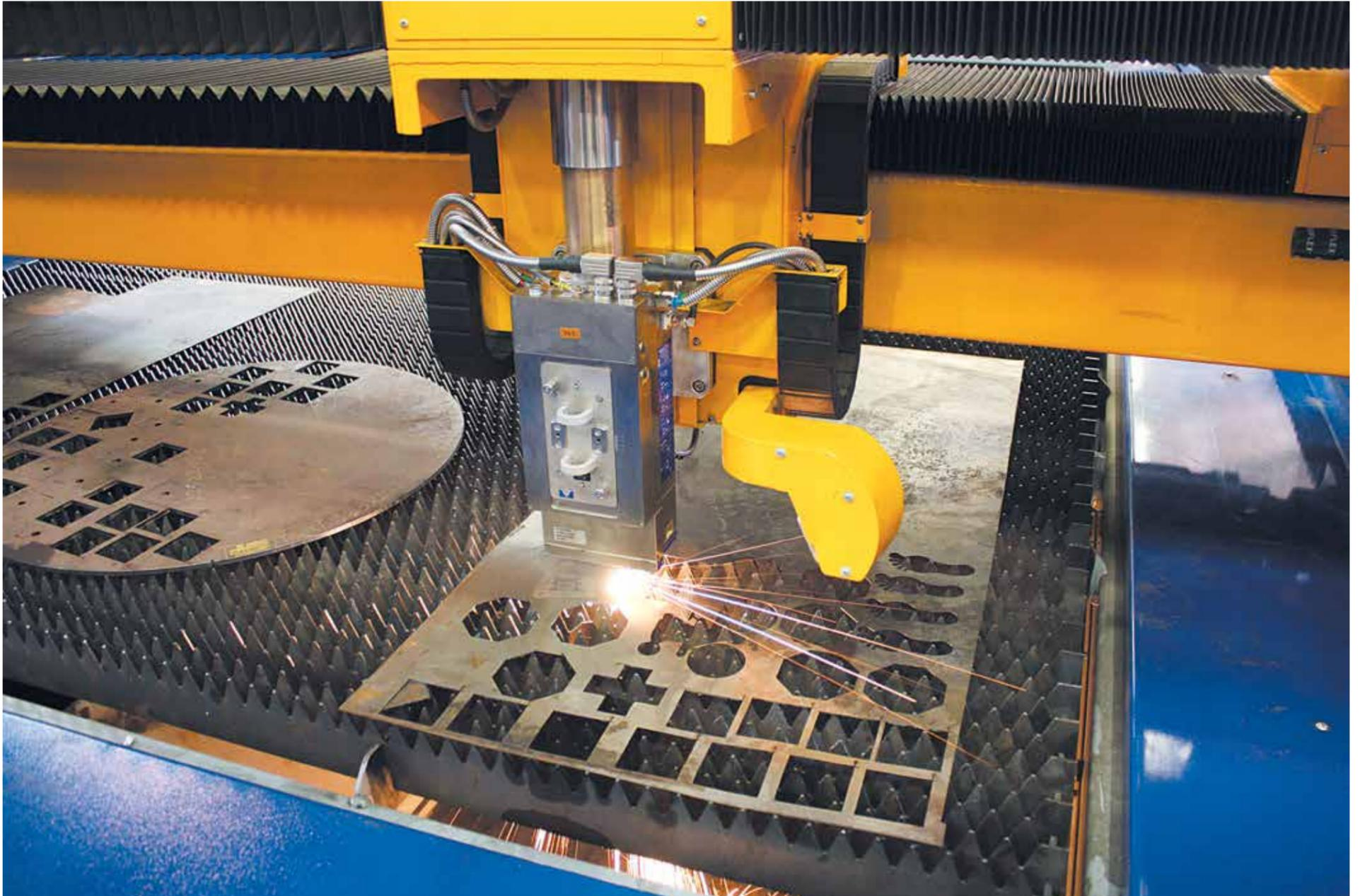
Las máquinas MicroLas de corte láser CO<sub>2</sub> están diseñadas para aplicaciones con altas exigencias en la precisión y la velocidad de corte con el fin de lograr unos costes de producción mínimos para grandes series de piezas. El robusto bastidor de la máquina, las guías lineales y los variadores de AC ofrecen excelentes propiedades dinámicas. La máquina está equipada de forma predeterminada con una mesa lanzadera automática.
