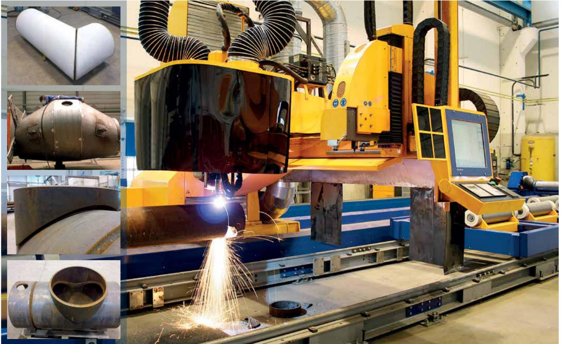
La CPCut es una línea de tubería y corte de perfiles diseñada para el procesamiento de una gran gama de diámetros y longitudes de tubería. El diseño modular de la máquina permite una amplia gama de aplicaciones incluyendo el corte de varias aberturas para múltiples tubos, intersecciones o conexiones, preparación de los bordes de soldadura y marcado de la tubería. Su campo de aplicación es la construcción de tanques, tuberías y plantas de energía.
