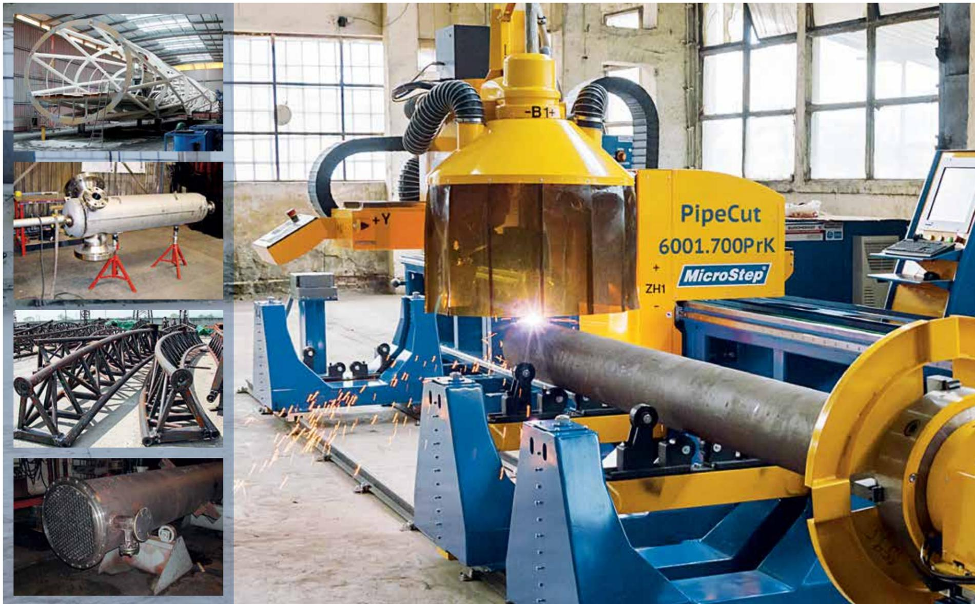
La máquina PipeCut ofrece una amplia gama de posibilidades de corte de tuberías y perfiles para diversas aplicaciones industriales en alta mar, oleoductos, centrales eléctricas, construcciones de acero y construcciones navales. El diseño modular de la máquina permite satisfacer las necesidades de fabricación de tuberías a medida y por lo tanto convertirse en una parte indispensable de la planta de producción del cliente.
