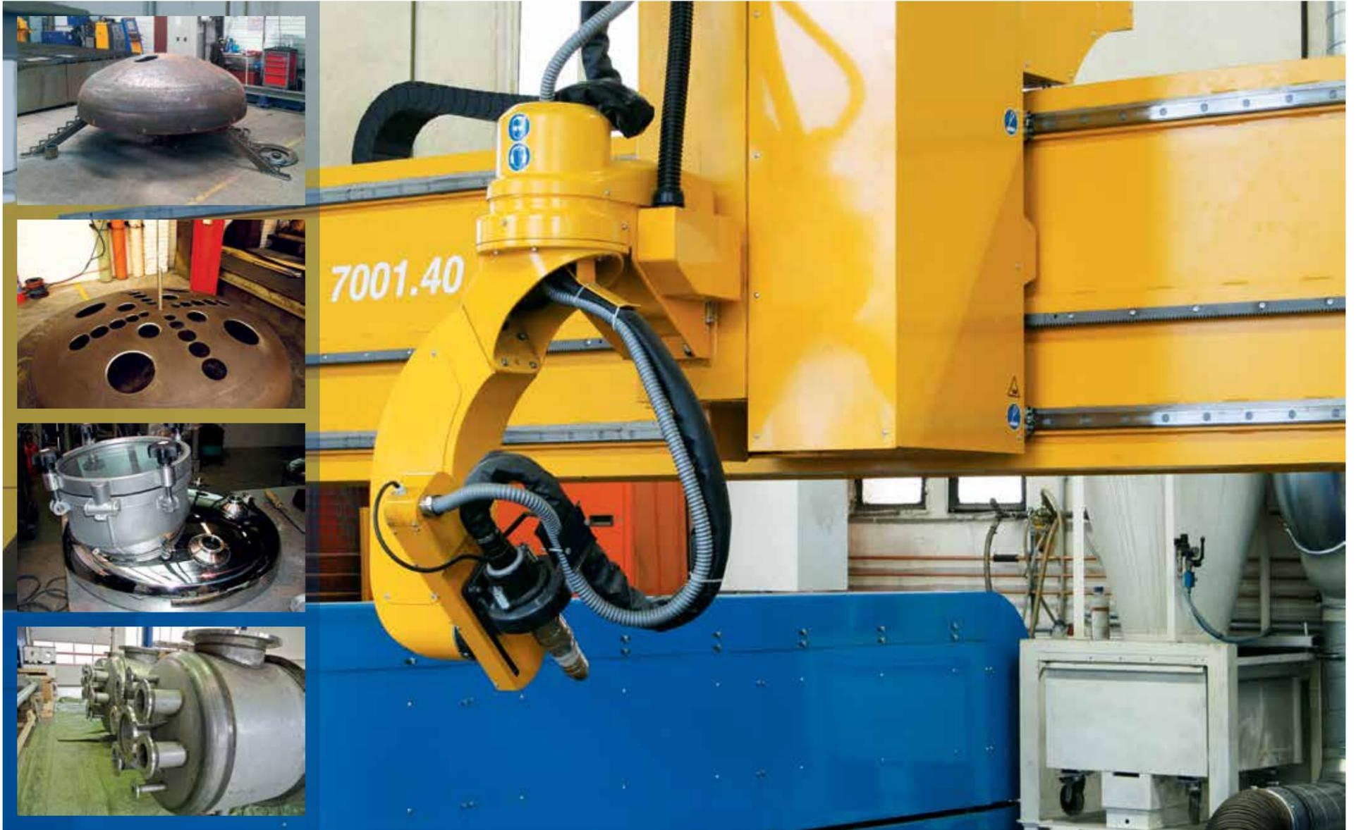
**D**RM-D es una máquina de corte CNC de alta resistencia diseñada para una amplia gama de aplicaciones de cúpulas, chapas y tubos. Su robusto pórtico permite operar sin vibraciones de maquinaria pesada como antorchas triples de oxicorte, un Rotator de 90° con una carrera de 1.200
