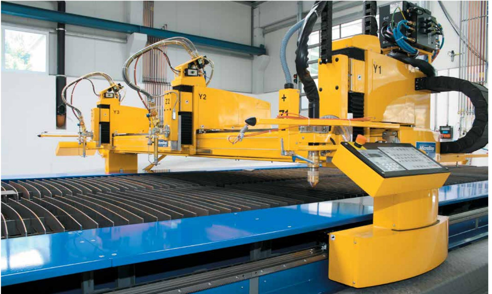
La PLS es una máquina de corte CNC de alta precisión con unas propiedades dinámicas excepcionales y un diseño moderno, desarrollado especialmente para una alta precisión de corte por plasma. Estas propiedades dinámicas se logran gracias a un pórtico inferior accionado por ambos lados, guías lineales de alta precisión y un sistema de accionamiento con bastidores helicoidales y piñones pretensados en todos los ejes. Opcionalmente incorpora el dispositivo de corte de tubos.
