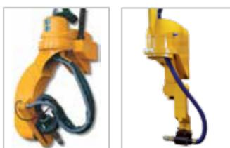
El cabezal de biselado de 6 ejes con capacidad de inclinación de hasta  $90^\circ$  permite el corte en bisel y corte de domos, tubos y perfiles, incluyendo la preparación de bordes para soldadura. Además el Rotator 3D con inclinación de hasta  $120^\circ$  permite el corte de perfiles en I, H, U y L.
