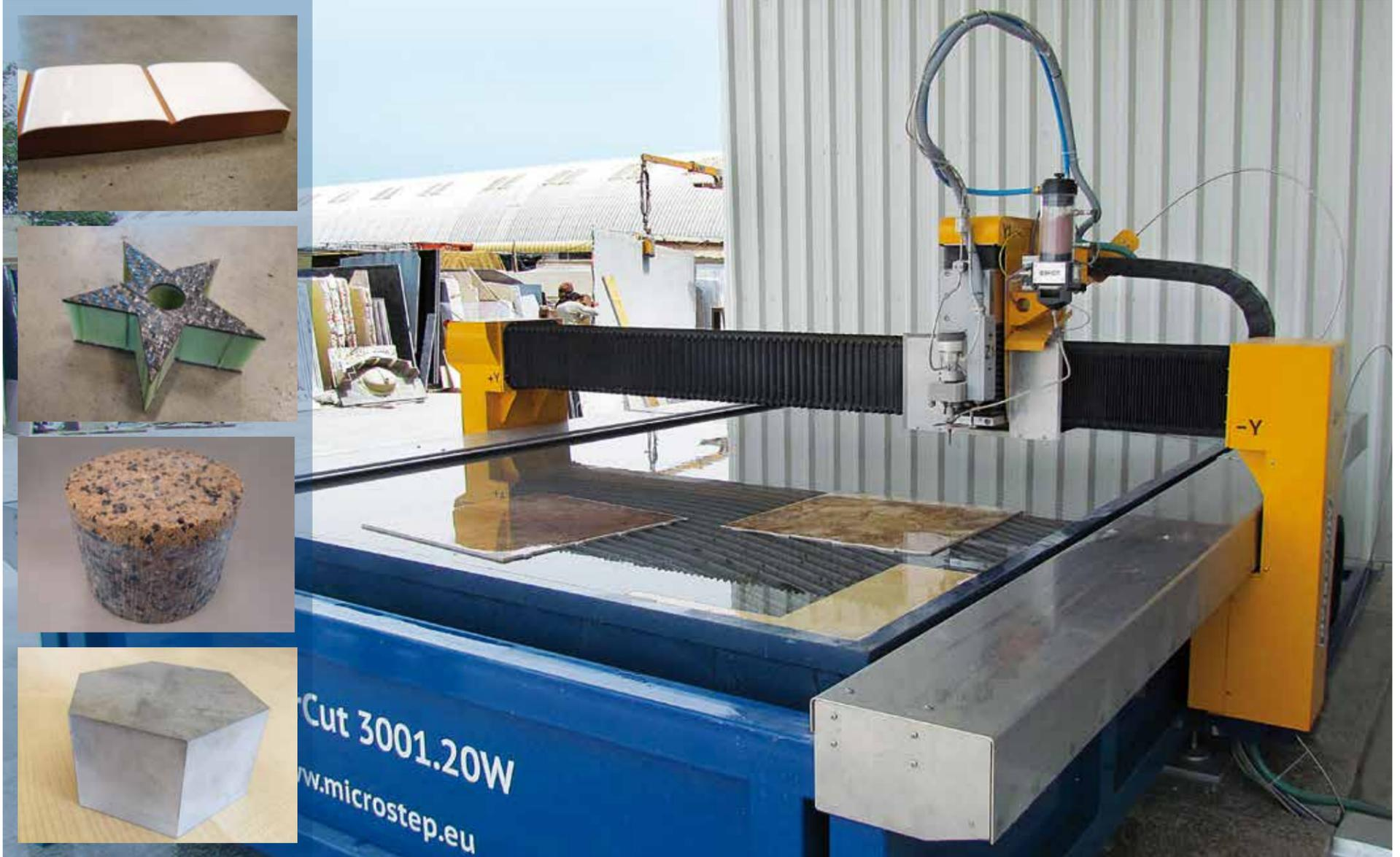
La WaterCut es una máquina de corte por agua de alta precisión y fiabilidad diseñada para el corte por chorro de agua directo o una combinación de plasma y chorro de agua. Puede equipar un cabezal multi-herramienta de una anchura de 1,200 mm, para transportar hasta 4 chorros de agua en el eje Z, o una unidad de perforación pequeña para materiales sandwich. El sistema de control por defecto es compatible con 5 calidades de corte con diferentes acabados.
