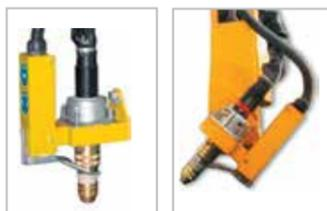
El cabezal de plasma tilting, incorpora un sistema de protección anticolidión, puntero láser, THC y una herramienta de marcado. El cabezal tilting permite el ajuste automático de inclinación de la antorcha hasta  $\pm 90^\circ$  para el corte en bisel.
