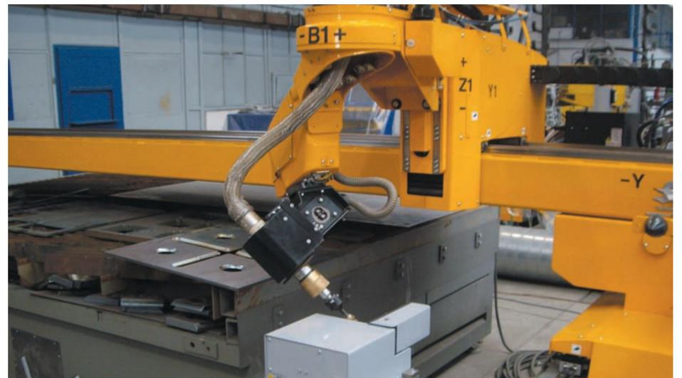
El sistema está formado por una sonda de antorcha con forma esférica, una estación de calibración situada al final de la máquina y el software de control correspondiente. Además, se ha diseñado un soporte de antorcha totalmente nuevo. El sistema ITH (Intelligent Torch Holder) pendiente de patente, puede detectar incluso las
