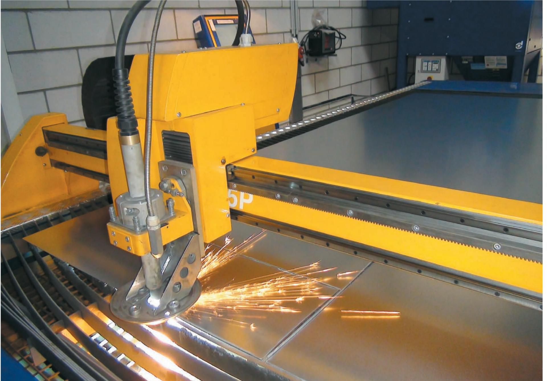
La AirCut es una máquina compacta diseñada para cortar conductos y planchas metálicas para la industria de la climatización y de la alimentación. Su estructura ligera con sistema de extracción de humos integrado cumple totalmente los requisitos de corte de materiales de chapa fina. Como la máquina puede estar equipada con un sistema
