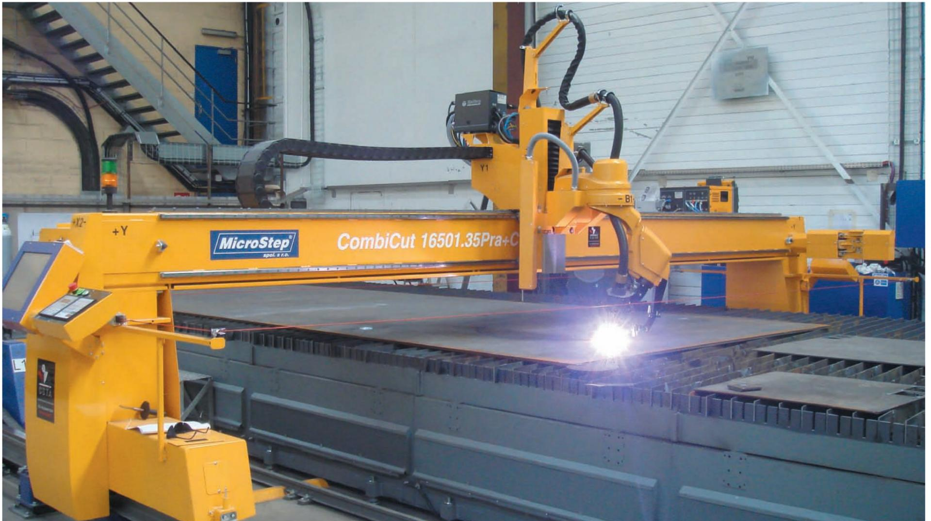
Esta robusta máquina CNC de gran precisión está diseñada especialmente para el corte por plasma y oxicorte de alto rendimiento multiturno. Permite cortar acero de hasta 300 mm, biselar con un par de antorchas triples
