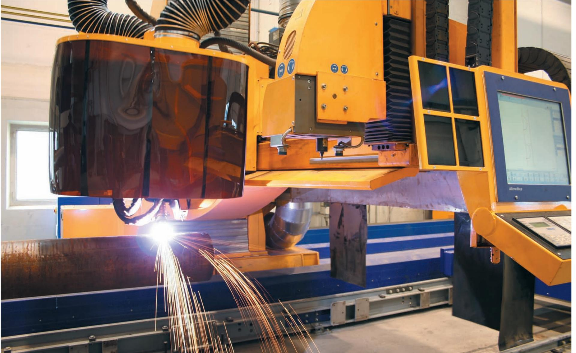
La CPCut es una máquina de corte de tubos y perfiles diseñada para procesar una gran variedad de diámetros y longitudes de tubos. El diseño modular y el funcionamiento variable de la máquina ofrecen una amplia gama de aplicaciones para tubos, como recortes, corte de varios orificios para múltiples intersecciones o conexiones de tubos y perfiles, preparación del cordón de soldadura, así como marcaje de tubos. Su campo de aplicación es la construcción de tanques, tuberías y plantas de energía.
