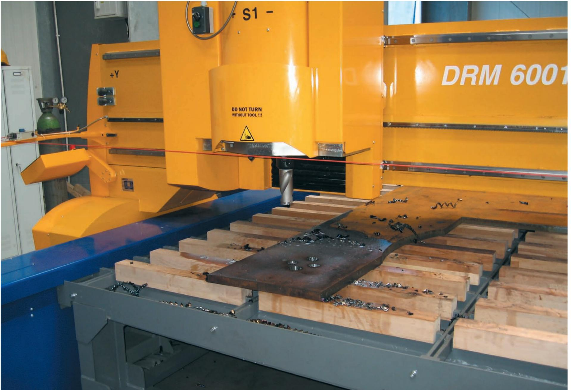
La DRM-B es una versión especial de la máquina DRM indicada para la perforación CNC de gran potencia de planchas de construcción, placas tubulares para intercambiadores de calor u otros trabajos de perforación exigentes. La máquina incorpora una tabla de perforación especial con plataformas de protección contra perforaciones y un almacén de herramientas giratorias para 16 herramientas e incluye la opción de marcaje
