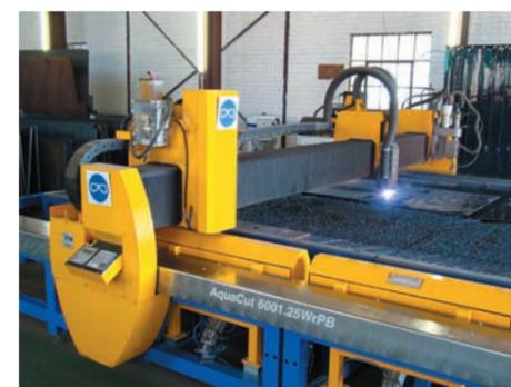
ce mesas de corte con transportadores de rodillos incorporados. Estos sistemas pueden integrarse en las líneas transportadoras existentes de la fábrica para así optimizar el flujo de materiales por la máquina.
