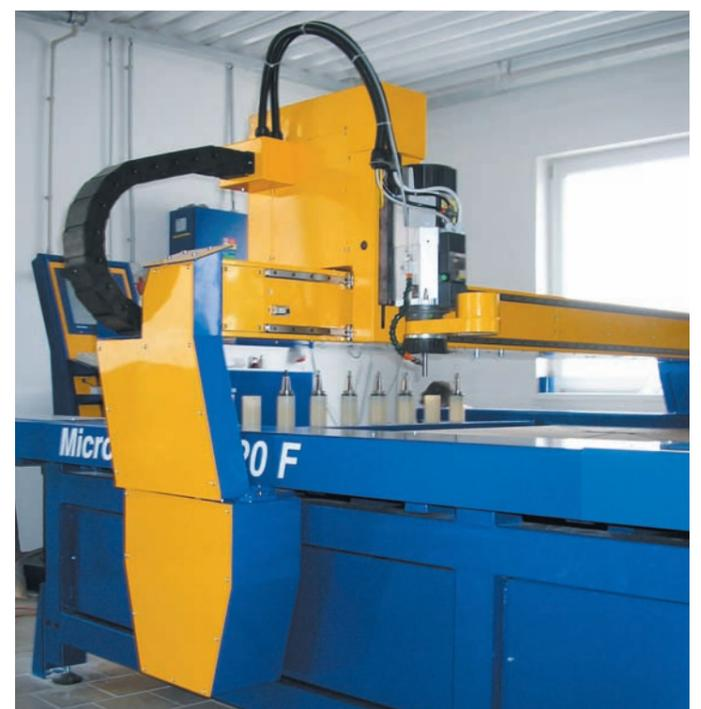
Las máquinas MicroMill están diseñadas para fresar en 3D metales ligeros, plásticos y madera mediante husos de alta revolución. Su construcción mecánica las hace adecuadas para la mecanización de formas de
