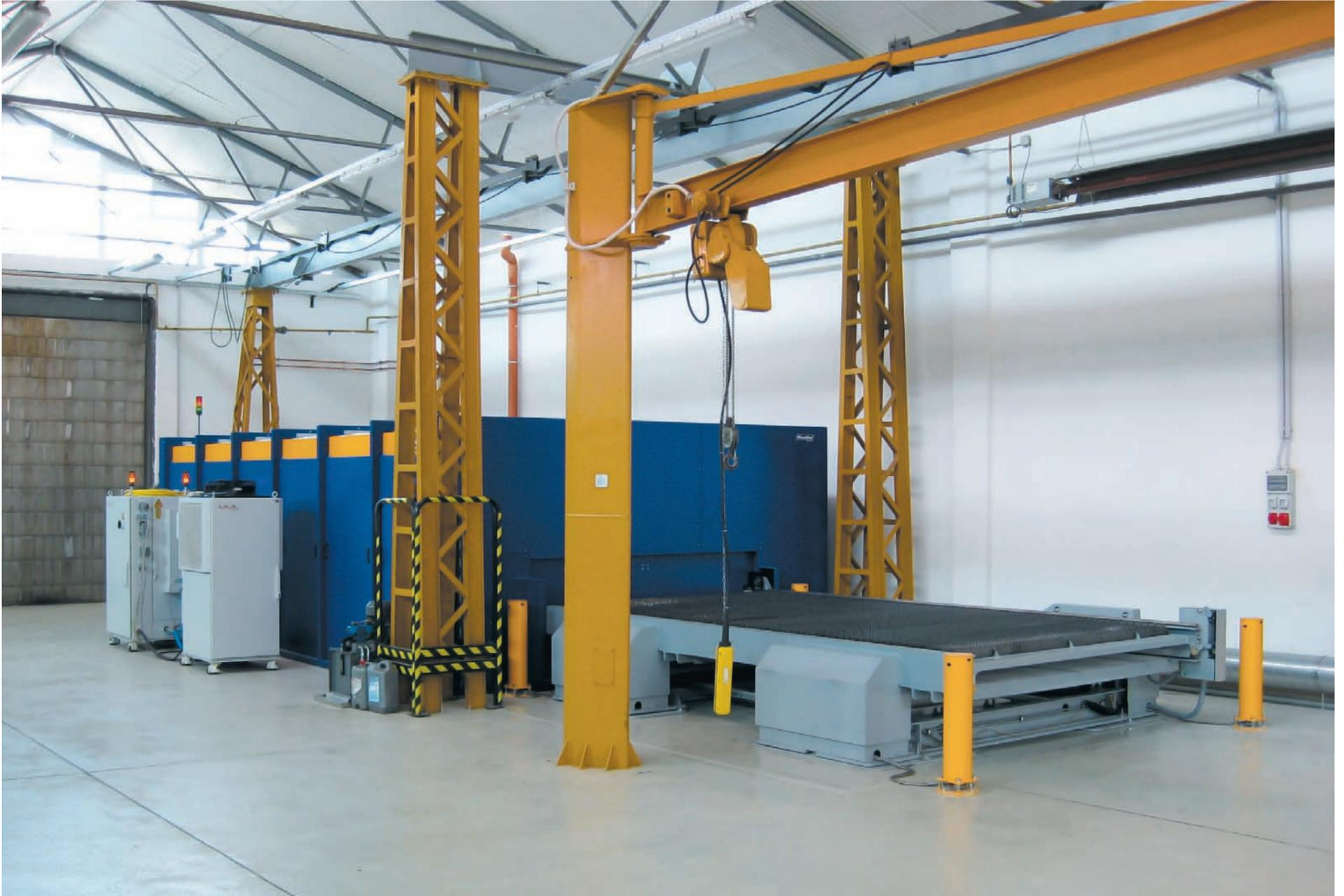
La máquina MSF es un potente sistema de corte por láser que permite cortar materiales con un láser de fibra óptica o una combinación de láser de fibra y plasma. Esta máquina está diseñada para producir piezas de gran precisión a grandes velocidades de corte, con unos costes operativos y de mantenimiento sorprendentemente bajos. La excelente dinámica de la máquina MSF se obtiene gracias a un pórtico situado
