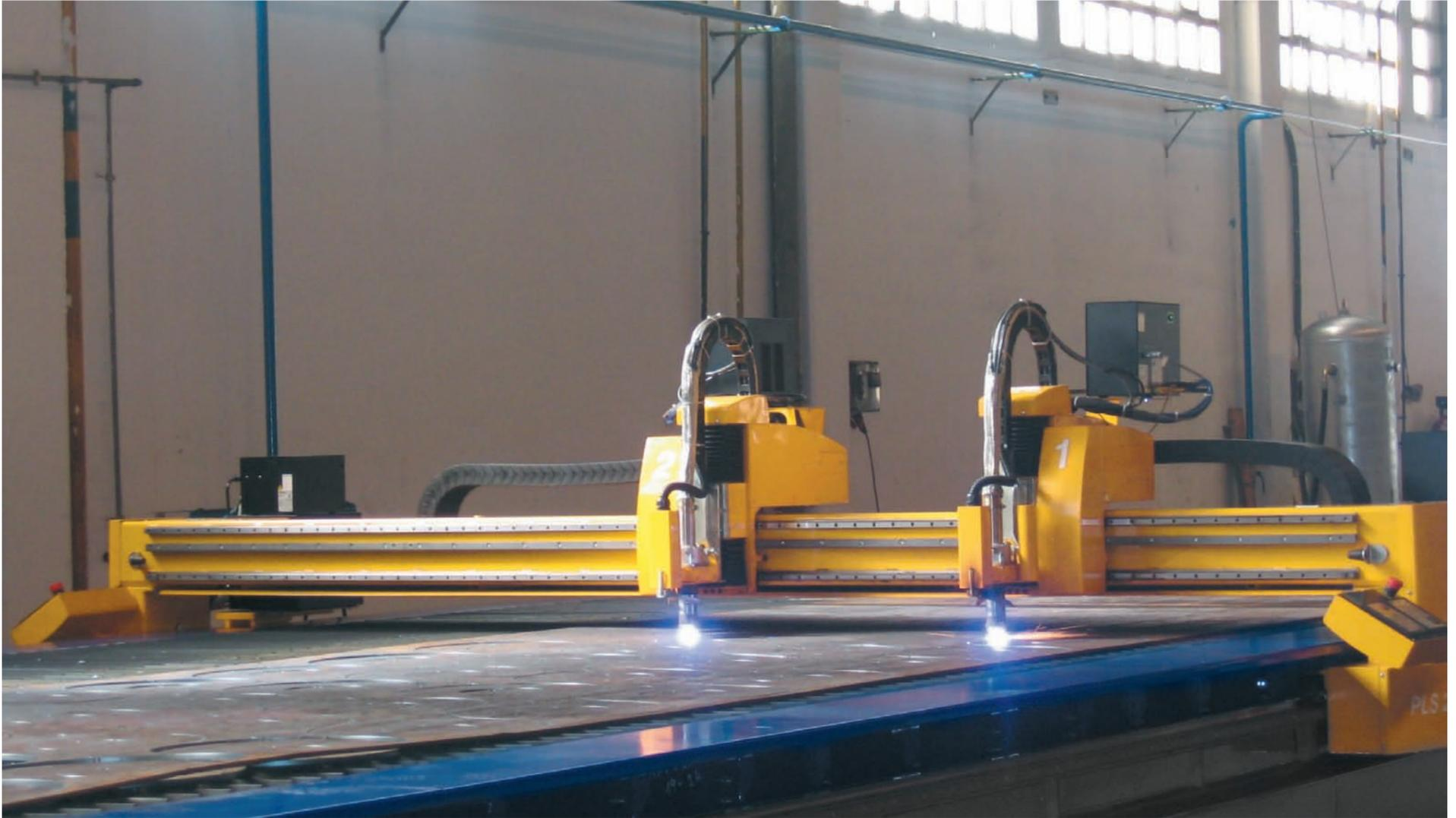
La PLS es una máquina de corte CNC de gran precisión con destacadas propiedades dinámicas y un diseño moderno, desarrollada especialmente para cortes por plasma de gran precisión. Consigue una excelente dinámica gracias al pórtico situado en posición inferior y accionado por ambos lados, a las guías lineales de gran precisión y a un sistema de accionamiento con cremalleras helicoidales y piñones pretensados en todos los ejes. Además de los accesorios estándar
