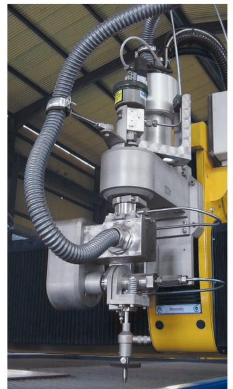
La AquaCut es una máquina de corte CNC de gran precisión diseñada para procesar una gran variedad de materiales, incluidos los que no pueden someterse a tensiones térmicas o mecánicas.
