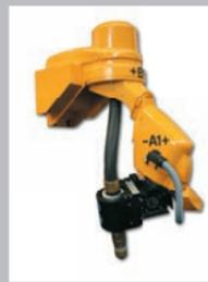
realiza mediante voltaje de arco de plasma y para obtener biseles de longitud variable se realiza mediante sensores inductivos.
